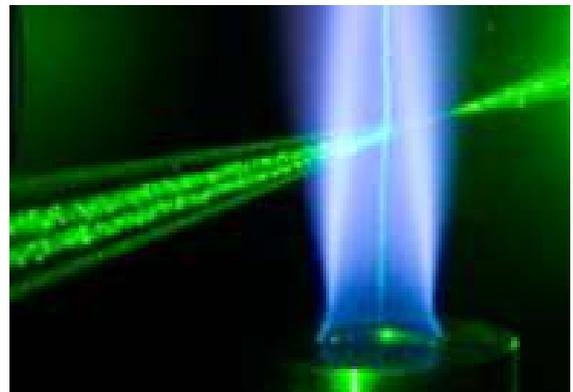
Laser-Raman Spektroskopie einer turbulenten Erdgasflamme mit Tropfeneindüsung. Die Erdgasflamme ist durch ihre bläuliche Chemolumineszenz erkennbar. Der Tropfenstrom, erkennbar als grüner vertikaler Strahl, verläuft in der Mitte der Flamme von unten nach oben. Die von links nach rechts verlaufenden Streifen markieren die Anregungs-Laserstrahlen für das laserbasierte Messverfahren.
