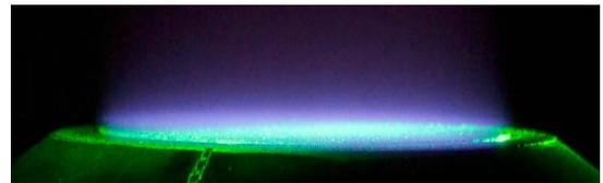
Brenner mit einer stationären Flamme.
